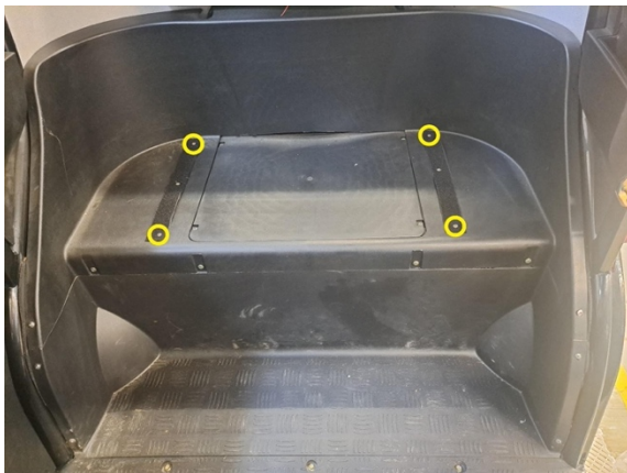
Irrota velcro tarranauhojen reunimmaiset kiinnitysruuvit. (ristipäämeisseli ph2).
