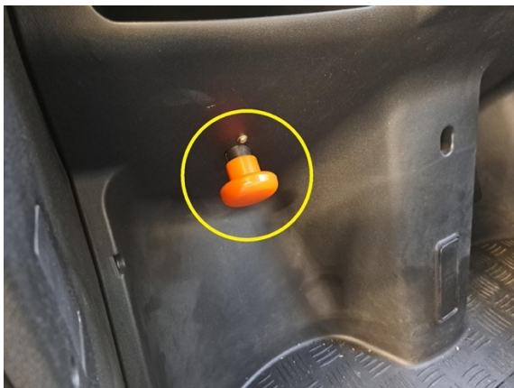
Paina päävirtakyttin kiinni.
